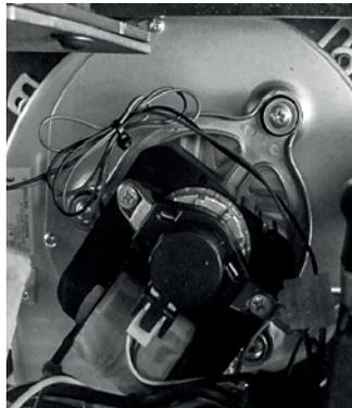
**Sicherheitsschalter** zum manuellen Resetieren des Wassertemperaturfühlers: Im Falle einer Temperatur von über 100° C wird der Ofen abgeschaltet, die Anzeigt „**Alar-sic-Fal**“, zurückgesetzt wird der Thermoschalter mittels Drücken (Kappe zuerst abschrauben)
