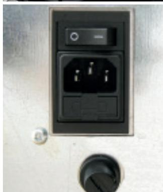
Der Ofen ist gegen Überspann (z.B. Blitzschlag) durch eine 4 A Sicherung geschützt (Rückseite des Ofens, Einschub unter dem Netzstecker). Weitere Sicherungen befinden sich auf der Hauptplatine.
