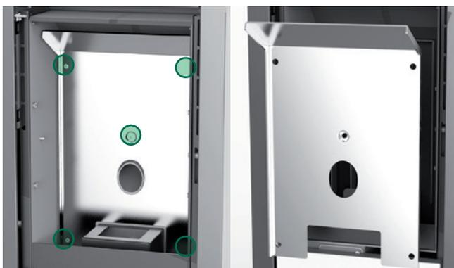
Entfernen Sie die fünf Schrauben, die das Schutzblech festhalten und heben Sie es heraus
